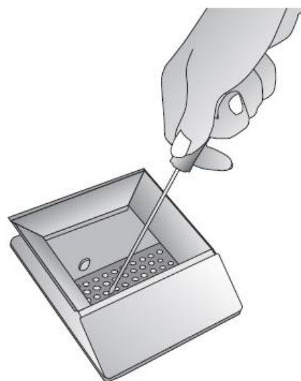
Billede 11: Rengøring af brændskålen
