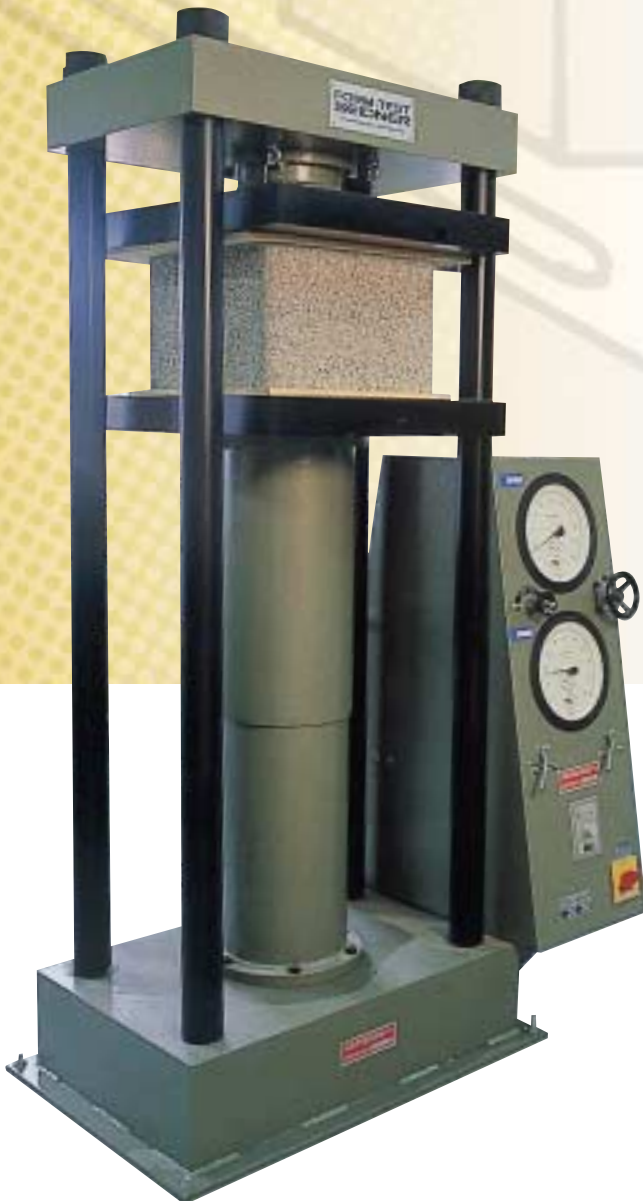
Trykprøvning. Her udsættes et element for et tryk svarende til flere hundrede meter skorsten.
