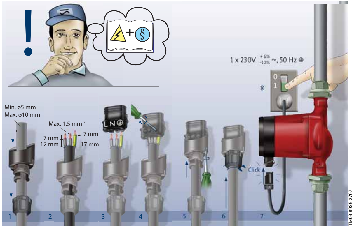
Fig. 6 EI-tilslutning
