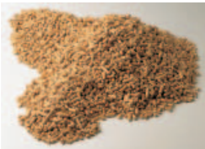
Let omstilling til træpiller ved montering af en pelletsbrænder på brænderlågen (ekstra udstyr). Træpiller fremstilles af biprodukter fra træindustrien, f.eks. af spåner og savsmuld, som presses til piller. 2,2 kg træpiller erstatter ca. 1 liter fyringsolie (vejledende brændeværdi).
